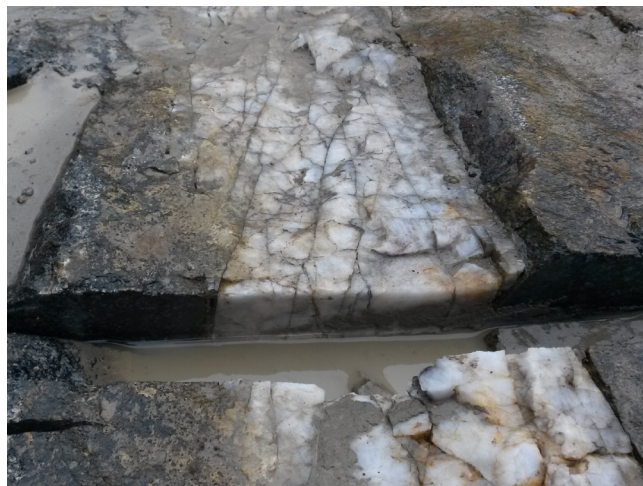
Bilden ovan visar på den kvartsgång som påträffats och ämnas brytas i Vargbäcken
