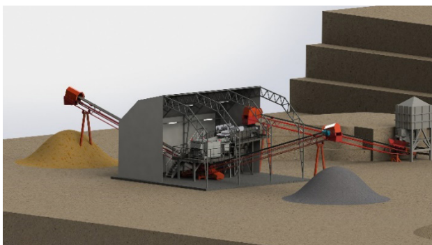
En tänkt anriktningsanläggning inklusive lasersorteringsutrustning
